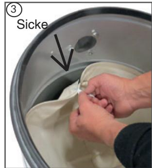
Überprüfen Sie vor dem Einsetzen des neuen Motorschutzfilters den Motorraum auf absolute Staubfreiheit. Staubpartikel können den Motor ernsthaft schädigen!
